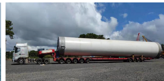
运输中的风机塔筒
